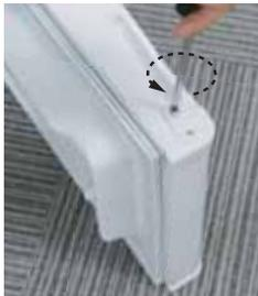
⑦上部ドア底面左側に左開き用ヒンジ受けを取り付けます。
