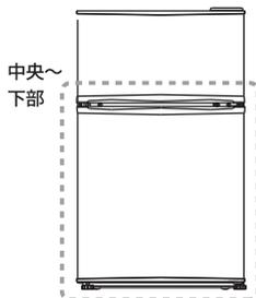
①プラスドライバーを使って中央部右側、2本のネジを外します。
