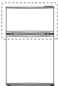
①マイナスドライバーを下図の囲い部に差し込み、ヒンジカバーを持ち上げて外します。
